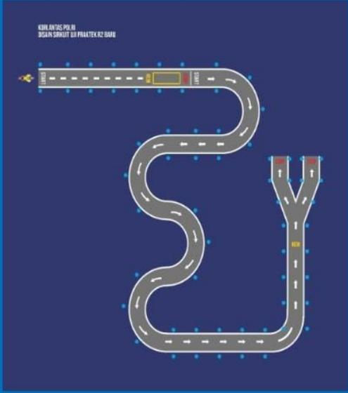
1. Perubahan lintasan menjadi sebuah sirkuit yang mengakomodir 4 materi ujian praktik dengan ukuran yang sudah diperlebar dan tanpa materi Zigzag test atau slalom test;
